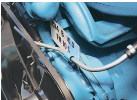
Keilriemen: monatelang gesuchtes NOS-Part mit korrekter Herstellerprägung – produziert wurde das Verschleißteil am 257. Tag des Jahres 1969
