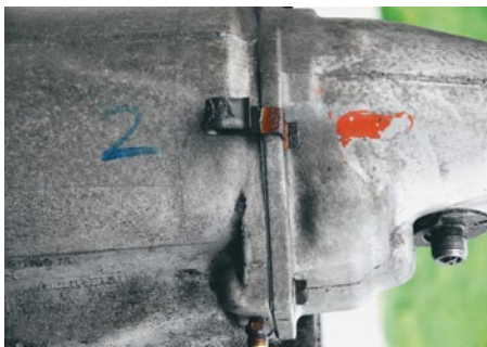
Kleckern, nicht klotzen: Die Filzstift-2 am Getriebe benötigte 70 Versuche zur Repro-Perfektion. Etwas länger brauchte der rote Kontrolltupfer. Nachdem der Lacküberschuss das Laufen lernte, wollte das schwere Bauteil axial gedreht werden – damit die Farbe exakt so verläuft wie 1970
