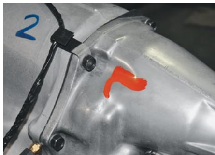
Kleckern, nicht klotzen: Die Filzstift-2 am Getriebe benötigte 70 Versuche zur Repro-Perfektion. Etwas länger brauchte der rote Kontrolltupfer. Nachdem der Lacküberschuss das Laufen lernte, wollte das schwere Bauteil axial gedreht werden – damit die Farbe exakt so verläuft wie 1970
