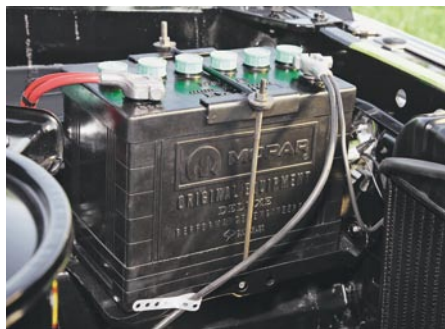
Batterie: Boden eines originalen Werksakkus von 1970 aufgesägt, alte Innereien durch neue Bleiplatten ersetzt – drei Wochen Arbeit
