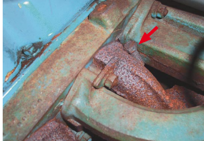
Schraube locker: Der komplette Motor wurde 1970 hängend lackiert. Beim Lösen vom Lackiergerüst fiel ein Haltebolzen zwischen die Krümmer und blieb dort – Zeit ist Geld. Heute ist der Bolzen ein Kleinod des Valiant als Gesamtkunstwerk
