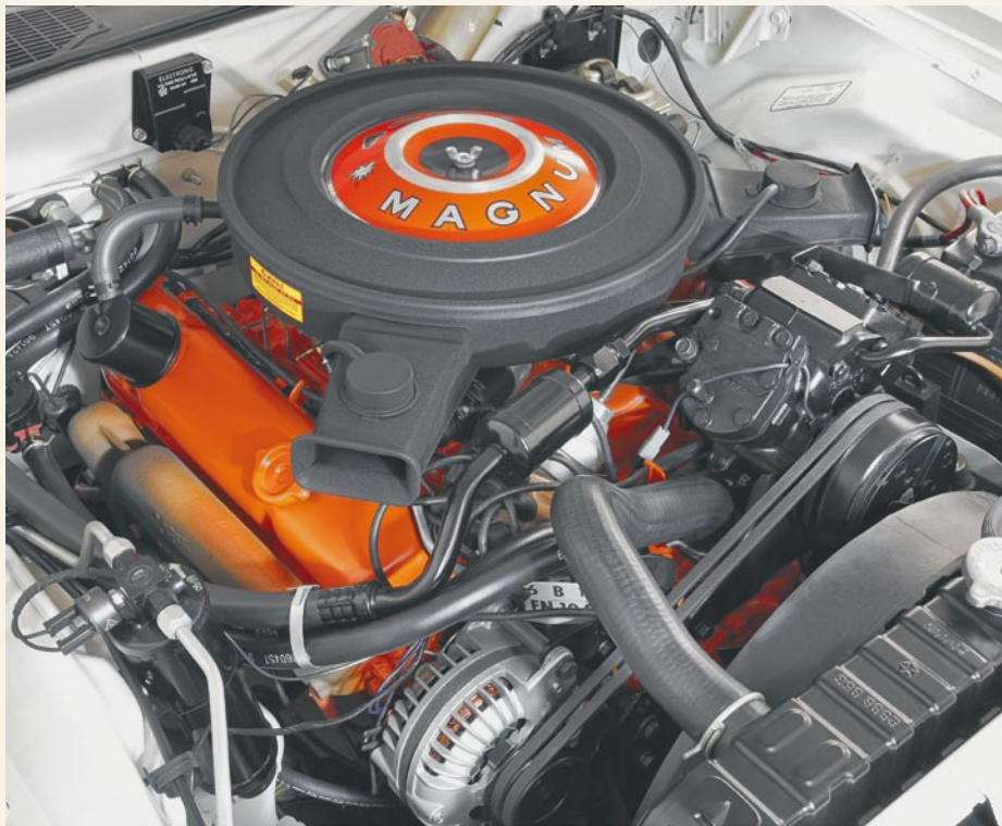
Großspuriger Name, viel dahinter: 440 Magnum steht für den Chrysler-V8 mit 7206 ccm Hubraum, Vierfachvergaser und 375 PS. Selten so korrekt: die leicht orangefarben benebelten Abgaskrümmer
